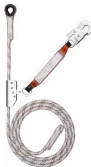
ANTICHUTE COULISSANT + CORDE Crochet double de sécurité Coulisseau anti-chute sur corde Ø 12 mm Absorbeur d'énergie 1 extrémité avec boucle cousée cousue et l'autre extrémité cousue évitant la sortie inopinée de l'appareil EN 353-2
