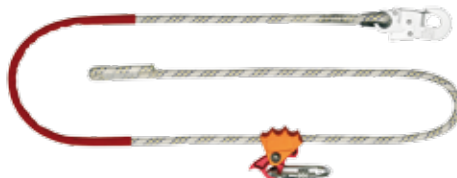
LONGE DE MAINTIEN Ø 14 mm Mécanisme de réglage et gaine de protection Longueur 3 m EN 358
