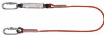
LONGE 1 BRIN EN DRISSE Ø 10,5 mm Absorbeur d'énergie 2 mousquetons acier à vis Longueur 2 m EN 355
