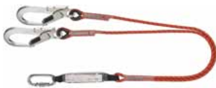
LONGE EN Y Ø 10,5 mm Absorbeur d'énergie 1 mousquetons acier à vis 2 mousquetons alu. grande ouverture Longueur 2 m EN 354 / EN 355
